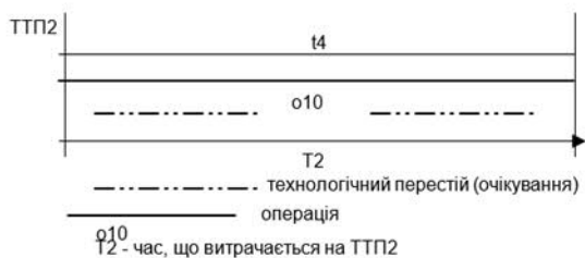
Рис. 2. Транспортно-технологічний процес перевезення агломерату
