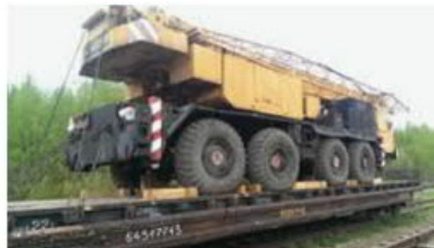
Рис. 2. Загальний вигляд кріплення на рухомому складі гусеничної та колісної техніки
