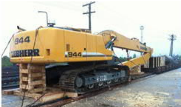
Рис. 2. Загальний вигляд кріплення на рухомому складі гусеничної та колісної техніки
