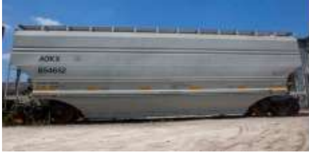
Рис. 8. Критий зерновий вагон-хопер з вигнутим бортом (Curved Side Grain Covered Hopper Car Tsunami Gate)
