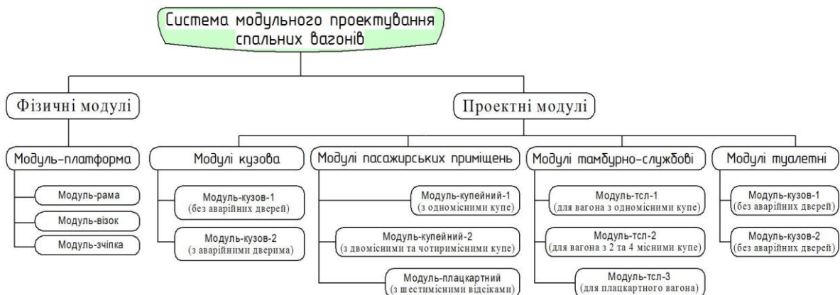
Рис. 19. Сукупність модулів системи модульного проектування спальних вагонів нової генерації
