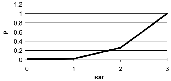
Рис. 2 Кумулятивна крива випадкових величин кількості передавальних поїздів, що прибувають на станцію протягом доби
